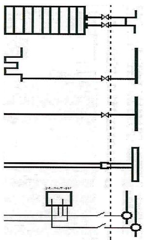
Отопление до первого запорно-регулировочного крана на отводах
